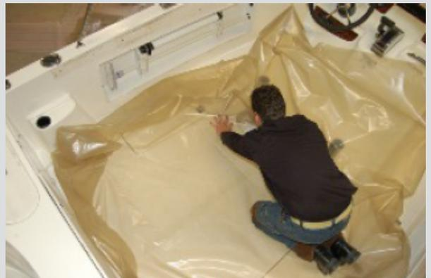
3. Nun muss die Folie an mehreren Punkten mit doppelseitigem Klebeband fixiert werden. Hierbei ist zu beachten, dass die Schablone in einem Stück gefertigt werden muss.
